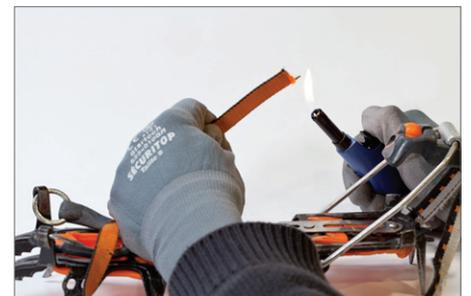
Halten Sie beim Auswechseln der Steigeisenriemen kurz eine Flamme an das Ende der Riemen.
